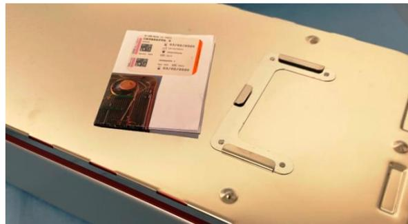
Tasca porta documenti realizzata in acciaio inossidabile AISI304 dim. 150x80 mm, fissata al copricoperchio per mezzo di ribattini in acciaio inossidabile. La tasca può essere utilizzata per il posizionamento di un foglio A4 piegato in 4 (es. check-list strumentario)
