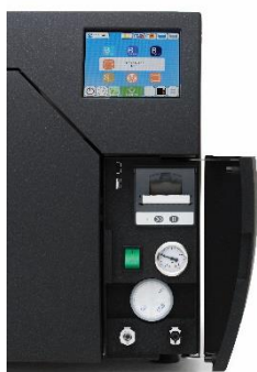
display e frontalino accessori (innesti rapidi carico/scarico acqua, filtro batteriologico, tasto accensione, vuoto manometro analogico, stampante incorporata e porta con chiavetta USB)
